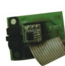
CWN-A019 储纬器纬纱检测板
